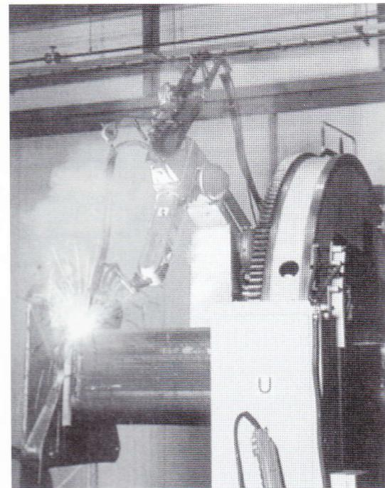
溶接ロボットシステム装置
