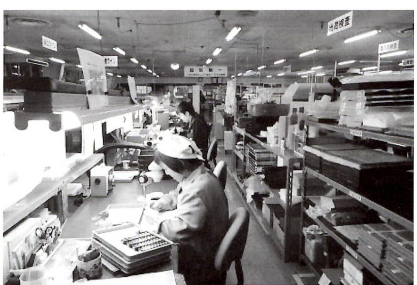
成形品に磁気ヘッドを組み付けた後の出来具合を、外観検査する
