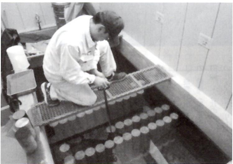
写真は上から、最新のプラント操作盤、中は圧縮試験、下はテストピース養生
