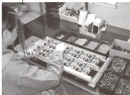
温度調節計の中に部品を刺し込む。人の手で丁寧に行なわれる。上は差しこんだ部品のはんだ付け作業。
